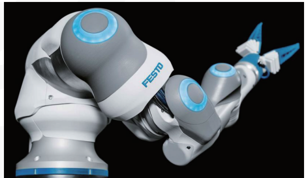
图 23：FESTO 公司柔性抓取机械手臂
