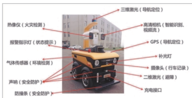
图 12：新松公司 5G 智能巡检机器人
